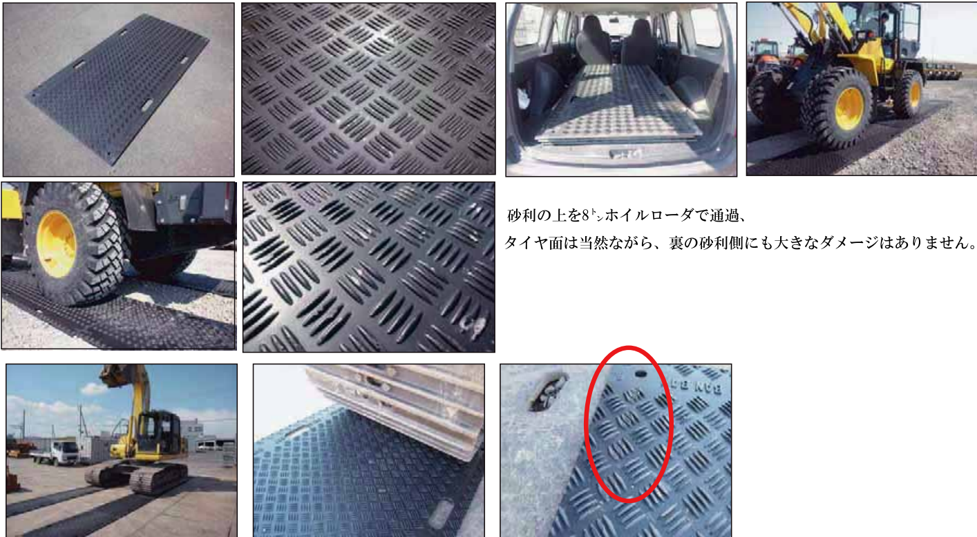
20tのキャタピラ車で通過、直進通過ではダメージが殆ど無く、360度旋回では致命的ではないが一部にダメージが残る。
